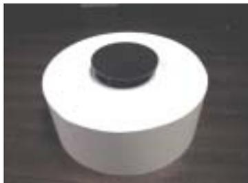
Figura 6-4. Inserte el eje en el rollo de papel nuevo.
