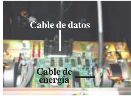
Figura 7. Conecte los cables de energía eléctrica y de datos.
