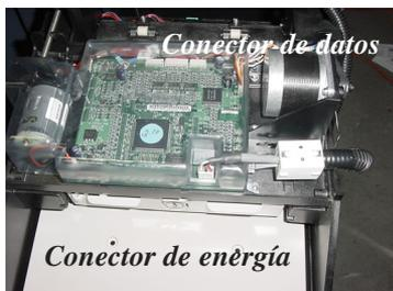
Figura 11. Conexiones de datos/energía.
