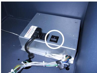
Fig. 7-3. Ubicación del interruptor de energía.
