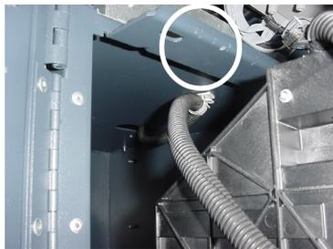
Figura 12. Cables guiados a través del gancho para cables.
