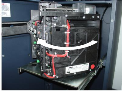
*Figura 4-4. Gire el mecanismo hasta la posición de servicio (en el sentido de las agujas del reloj).*
