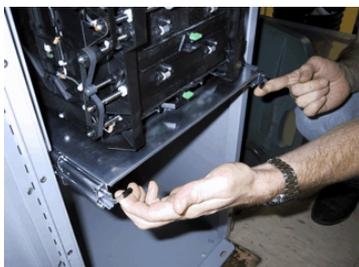
Figura 4-1. Levante hacia arriba las palancas de cierre de la bandeja deslizante.
