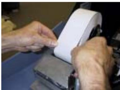
Figura 6-6. Cómo alimentar con papel la ranura receptora de la impresora.
