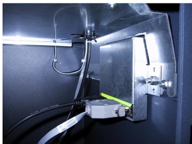
Figura 2. Asegúrese que los cables de datos estén conectados al módulo de Registro electrónico.
