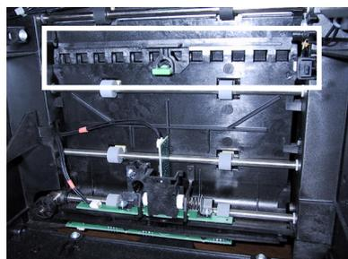
Fig. 7-5. Ubicación de la compuerta de acceso interna.
