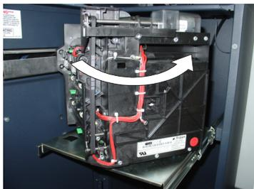
Figura 4-15. Gire el mecanismo para colocarlo en la posición de funcionamiento (en sentido contrario a las agujas del reloj).
