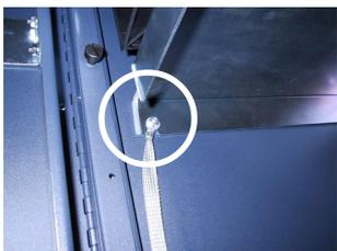
*Cinta de conexión a tierra asegurada al perno de montaje de la bandeja dispensadora.*
