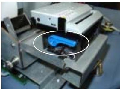
Figura 6-10. Palanca de tensión azul (posición correcta).
