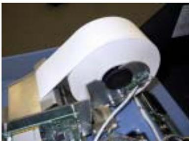
Figura 6-7. Un nuevo rollo de papel instalado en la impresora.
