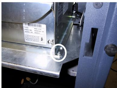
Figura 4. Asegure el armazón del mecanismo a la bandeja utilizando dos pernos.
