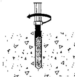
Figura 6. Guíe la varilla de anclaje dentro de la cápsula utilizando un taladro de percusión.
