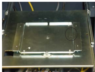
Figura 4. Placa giratoria en la posición de funcionamiento. Observe que el agujero de la placa está a la derecha.
