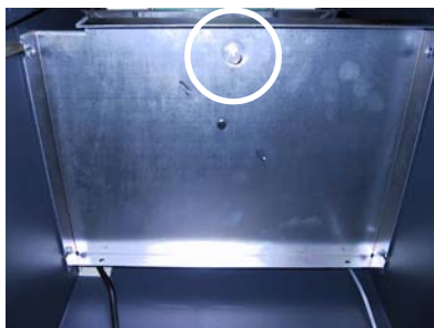
Figura 5. Ubicación del perno que libera la placa giratoria en la superficie inferior de la bandeja del dispensador.
