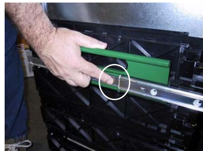
Figura 4. Apriete en ambos lados por la varillas de metal en los rieles para permitir sacar el dispensador de los rieles.
