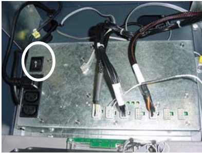
Figura 1. Interruptor sobre el lado izquierdo del módulo de la energía.
