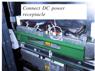
Figura 7. Conecte el enchufe de poder de corriente continua al receptáculo mostrado encima
