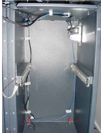
La figura 1. Asegure la energía y las cordón del teléfono se encaminen a través de los clips de cable.
