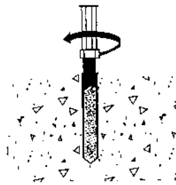
Fig. 6. Conduzca la barra de anclaje en la cápsula usando una perforadora de percusión rotatoria.
