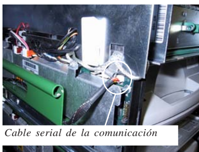
Figura 8. Conecte el cable de serie de comunicación al mecanismo de distribución como es mostrado. (Adelante la mayoría de los conectores)
