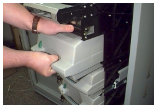
Figure 4-17b. Dépose de la cassette à rejets.
