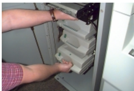
Figure 4-7a. Dépose de cassette.
