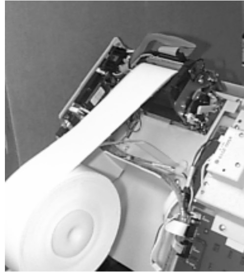
Figure 6-8. Nouveau rouleau de papier installé sur l'imprimante.
