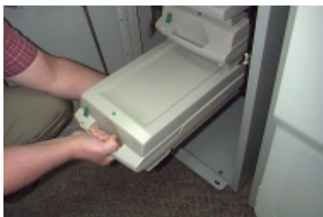
Figure 4-7c. Dépose de cassette.
