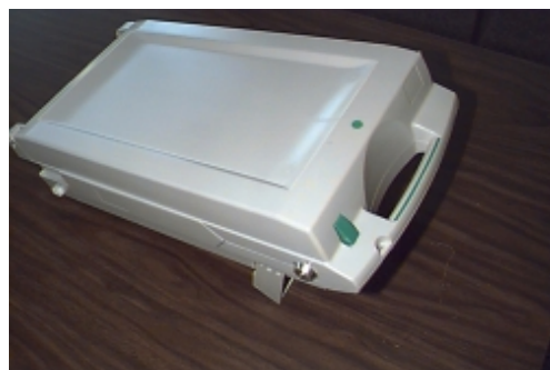
Figure 4-8. Bras de chargement de la cassette abaissé.
