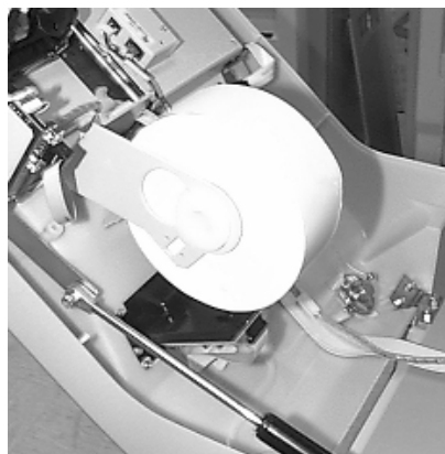
Figure 6-6B. Rouleau de papier et bobine en place pour le fonctionnement.
