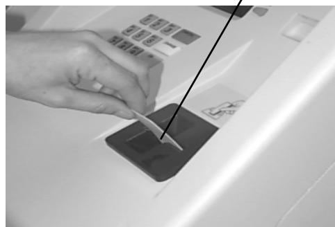
Figure 6-1. Utilisez les cartes de nettoyage une fois par mois pour conserver le bon fonctionnement du lecteur de carte.
