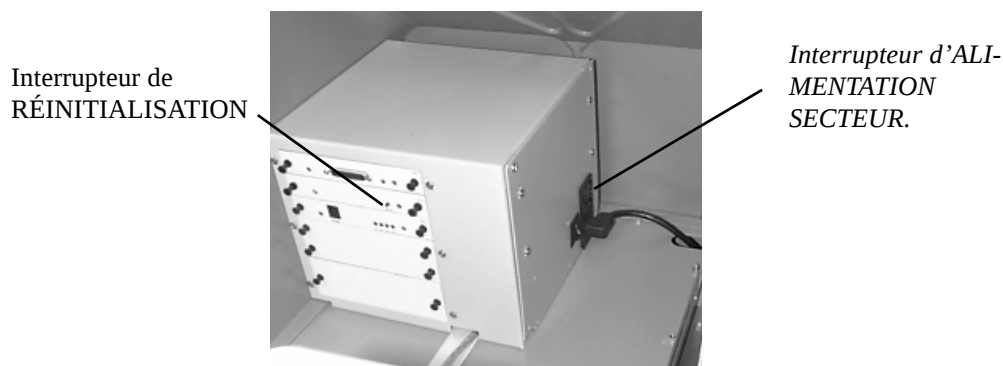
Figure 8-2. Emplacement de l'interrupteur d'alimentation secteur.
