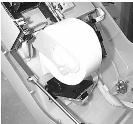
Figure 6-6A. Mise en place de la bobine et du rouleau de papier sur le support à papier.
