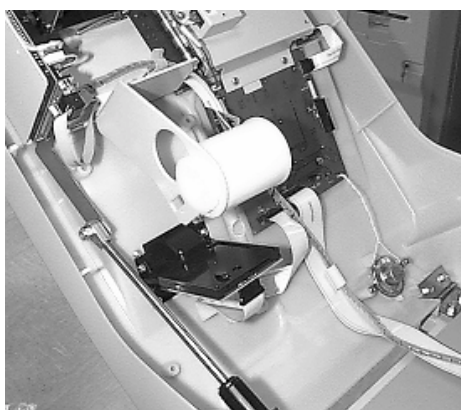
Figure 6-4A. Bobine de papier en position de fonctionnement normal.
